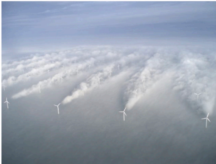
Wolken verdeutlichen die Turbulenzen im Windpark Horns Rev 1, Dänemark.
